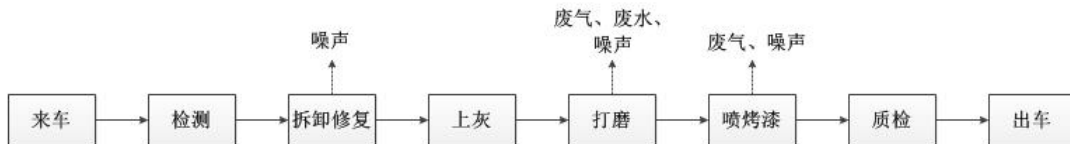
图 5-2 项目喷烤漆工艺流程图及产污环节
