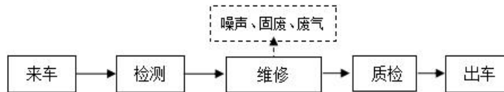
图 5-1 项目维修工艺流程图及产污环节
