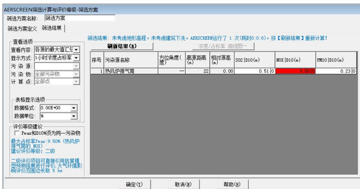
图 3 热风炉燃烧尾气污染物最大落地浓度占标率估算截图
