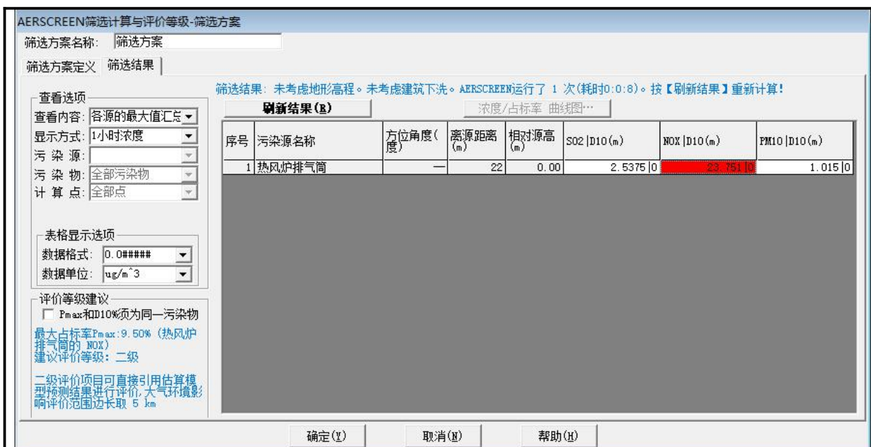
图 2 热风炉燃烧尾气污染物最大落地浓度估算截图
